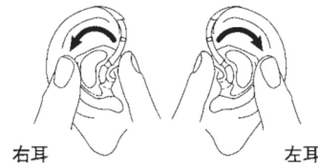
(3)右図のように補聴器を耳の後ろに乗せます。
