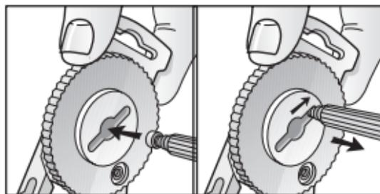
(4)新しい耳あかガードを窓に合わせた後、治具の反対側の先端を新しい耳あかガードに差し込み、上に引き上げます。
