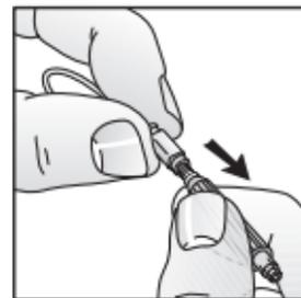
(3)(2)で抜き取った耳あかガードは図のように、中心の穴に入れ、外向きにずらして治具から外します。
