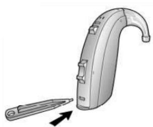
Werkzeug in Batteriefachverriegelung einführen.
