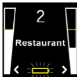
Batteria scarica su Remote Control 2
