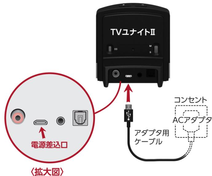
ACアダプタをコンセントに差し込み、アダプタ用ケーブルを電源差込口に差し込んでください。
