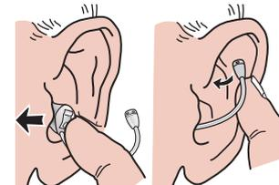
補聴器が耳の入口におさまるまでやさしく押し込んでください。マイクチューブを耳の形状に沿わせて装着してください。
