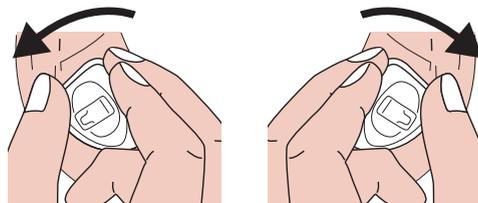
音の出口側を耳の穴に入れ、補聴器を矢印の方向(前から後ろ)へ少しねじりながら、耳にピッタリと収まるまで押し込んでください。
