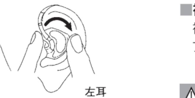
(3)右図のように補聴器を耳の後ろに乗せます。
