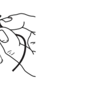
(4)(2)とは逆の方向にミニチューブを回して、本体に接続してください。
