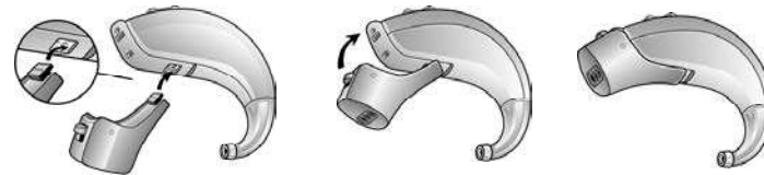
Anbringen des aufsteckbaren DAI-Adapters an ReSound ENZO 3D, Modell 88.
