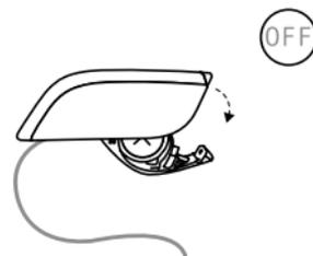
Zum Ausschalten des Hörsystems öffnen Sie (mit dem Fingernagel) die Batterieklappe.
