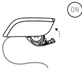
Zum Einschalten des Hörsystems schließen Sie die Batterieklappe.
