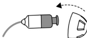
1. Entfernen Sie den alten Dome, indem Sie den Hörer abziehen, und entsorgen Sie ihn. Eventuell müssen Sie dafür etwas Kraft aufwenden.
