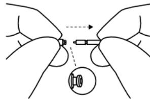
3. Ziehen Sie das Instrument gerade heraus – der neue Cerumenfilter bleibt in seiner Position. Bringen Sie den Dome wieder an oder setzen Sie einen neuen Dome ein.
