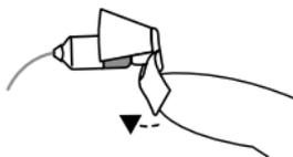
3. Kontrollieren Sie, ob der Tulpen-Dome richtig sitzt: Der Kragen muss das Schlauchende mit der Einkerbung vollständig umschließen.
