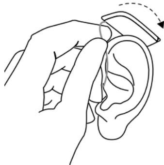
1. Halten Sie die Otoplastik mit Daumen und Zeigefinger und positionieren Sie die Schallaustrittsöffnung im Gehörgang.
