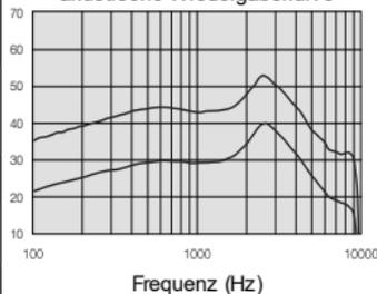
Gemessen nach ANSI S3.22-2014, IEC 60118-0:2015, JIS C 5512: 2015, 2 cm<sup>3</sup> Kuppler.\*Die Telefonspule ist nur für die Modelle RT962-DRW, RT762-DRW erhältlich.
