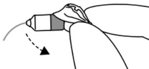
3. Kontrollieren Sie, ob der Dome richtig sitzt, indem Sie den unteren Teil des Domes vorsichtig anheben: Der Kragen muss das Schlauchende mit der Einkerbung vollständig umschließen.
