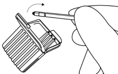
1. Entfernen Sie den Dome vom Verstärker des Hörers.
