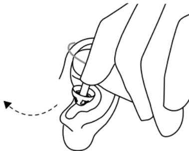
2. Fassen Sie den Hörschlauch am Knick und drücken Sie den Dome in den Gehörgang.
