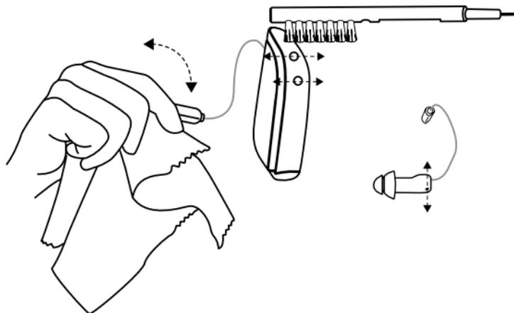
2. Säubern Sie die Mikrofone mit der kleinen Bürste. Wenn Ihr Hörer über ein Mikrofon verfügt, sollten Sie dieses auch reinigen.
