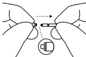
3. Führen Sie die Entnahmeseite in den alten Cerumenfilter ein und ziehen Sie das Instrument gerade heraus. Es sollte auf keinen Fall schräg herausgezogen werden.
