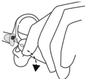
1. Heben Sie das Hörsystem von hinten über Ihr Ohr. Lassen Sie es für einen Moment neben dem Ohr hängen..
