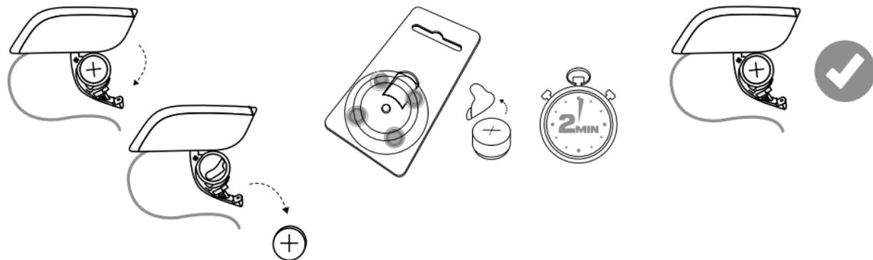
1. Öffnen Sie die Batterieklappe mit dem Fingernagel. Nehmen Sie gegebenenfalls die alte Batterie heraus.
