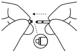
1. Führen Sie das andere Ende des Instruments in die Schallaustrittöffnung ein (das Ende mit dem neuen Filter).
