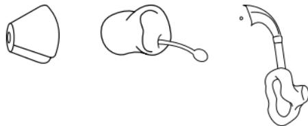
Utilice únicamente recambios originales del fabricante, como tubos y acopladores.
